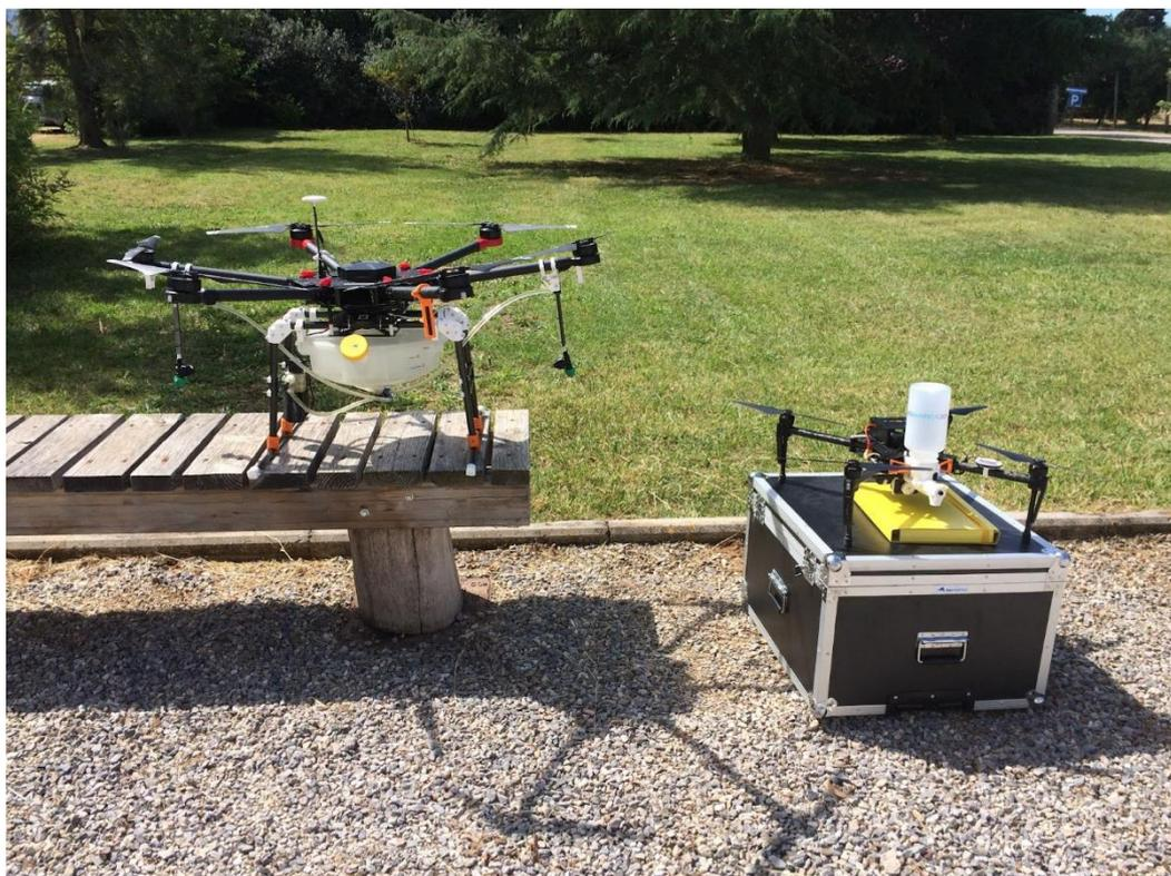
Figura 12. Modelli di droni utilizzabili in agricoltura. Il modello più piccolo a destra è stato uno di quelli utilizzati per la dispersione del polline all'interno degli oliveti.
