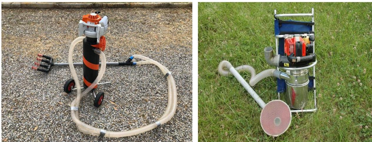
Figura 6. Modelli di aspiratori di polline utilizzati per le prove del progetto. A sinistra un modello a terra, a destra una versione a spalla, molto più comodo da utilizzare in caso di terreni con asperità od inerbimenti.
